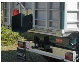
Bei der hinteren Anhängerkupplung von Anhängern gelten die gleichen Bestimmungen wie für Zugfahrzeuge. Die Anhängerkupplung muss stabil befestigt sein, sie muss drehbar sein und sie muss gekennzeichnet sein. Die Anhängelast muss auf dem Typenschild und im Fahrzeugausweis des Anhängers eingetragen sein.
